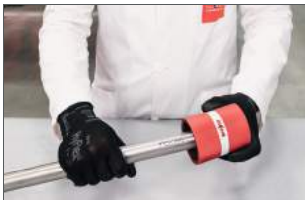
Sbavatura del tubo / Deburring the pipe
